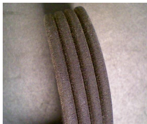
Пример модифицированного поликлинового ремня
